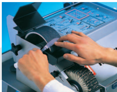
Заточка столового ножа на камень для волнистой заточки
