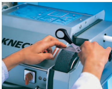
Заточка ножниц на ленте для заточки с охлаждением
