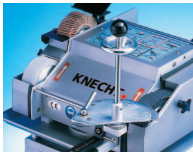
Куттерный нож затачивается в зажимном устройстве HV 161
