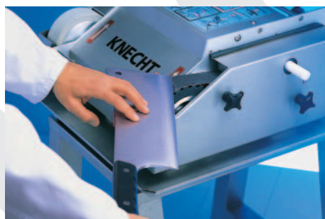
Разрубной нож затачивается на шлифовальной ленте
